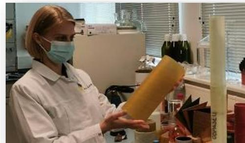
Обсадная труба из сверхпрочного полимера – полидициклопентадиена. Фото: Роснефть
