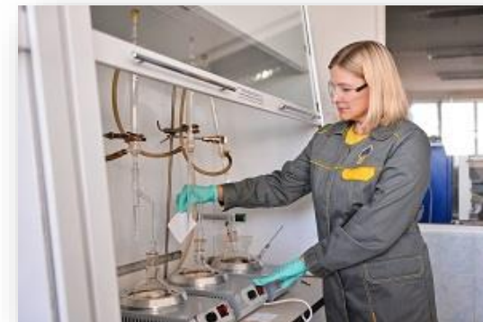
Специалист ООО «РН-ЦИР» проводит испытание масла TDAE Фото: «Роснефть»
