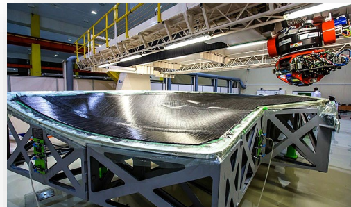
Преформа панели крыла из углеродной ленты «Роболэн».
