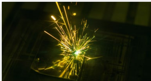
Процесс нанесения защитной голограммы на металлическую поверхность. Фото: Дмитрий Григорьев / ИТМО.NEWS
