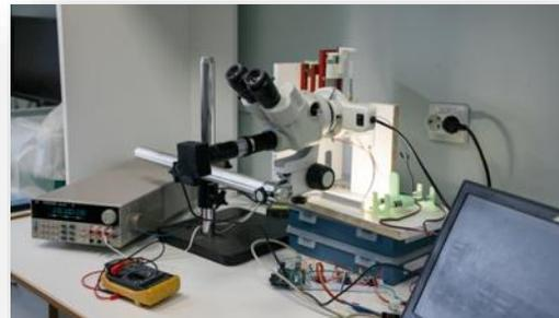
Прототип зондовой установки, позволяющей изучать характеристики тонких материалов. Фото: ЛЭТИ
