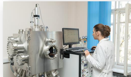
Руководитель группы разработчиков СПбПУ Ольга Квашенкина в лаборатории у установки магнетронного напыления. Фото: Стимул
