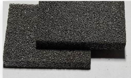
Образец углеродно-композиционного материала «Углекон-МЯ».
