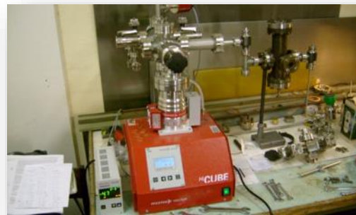
Установка для оптимизации технологии ионно-плазменной дезактивации отработанного ядерного топлива. Фото: scientificrussia.ru
