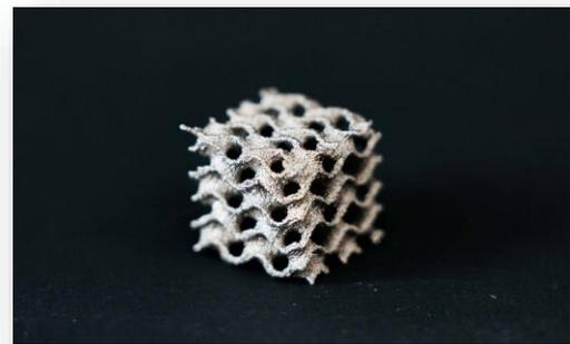
Пористые каркасы - скэффолды - из сплава титана и ниобия. Фото: [rscf.ru](http://rscf.ru)
