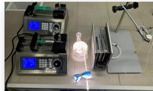
Микрофлюидный реактор для синтеза силиконов. Фото: И. Гончарова / РНФ
