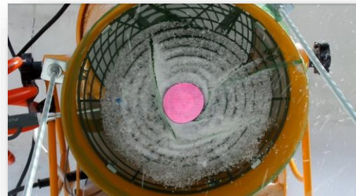
Фотофиксация процесса сброса льда. Фото: пресс-служба Пермского Политеха
