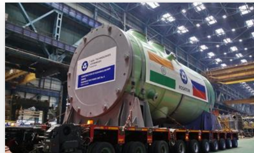
Корпус реактора ВВЭР-1000 для шестого энергоблока АЭС «Куданкулам». Фото: rosatom.ru
