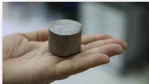
Образец аэрогеля, созданного в ИПХФ РАН (г. Черноголовка). Фото: ИПХФ РАН
