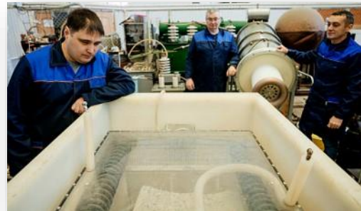
Установка для дезактивации бетона, разработанная специалистами ТПУ. Фото: Стимул / А.Юдин
