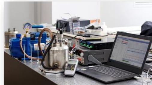
Образец малогабаритного прецизионного лазерного инклинометра, резистивного к изменениям температуры окружающей среды. Фото: ОИЯИ
