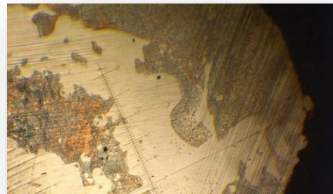
Чередующиеся участки бронзы и стали в сплаве от исследователей Сколтеха. Фото: Константин Макаренко и др./Materials & Design
