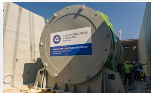
Корпус реактора для АЭС «Аккую». Фото: rosatom.ru
