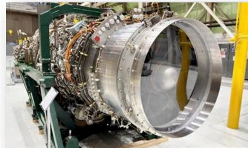
Опытный образец газотурбинного двигателя НК-36СТ-25. Фото: rostec.ru
