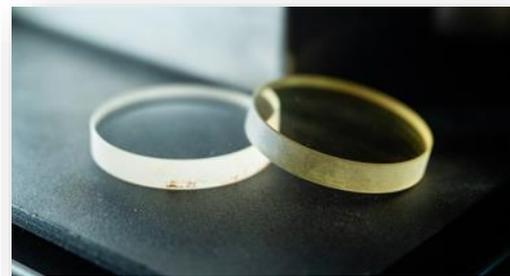
Образцы защитного покрытия для солнечных батарей, оптики и лазерной техники. Фото: пресс-служба МИСИС
