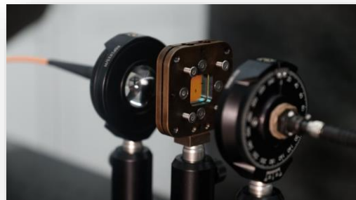
Фотонно-кристаллический микрорезонатор с жидкокристаллическим слоем. Фото: А.Тамаровская / ФИЦ КНЦ СО РАН
