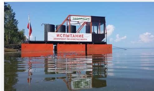
Речное судно со специальным оборудованием для сбора цианобактерий Фото: «Биотехкомп»
