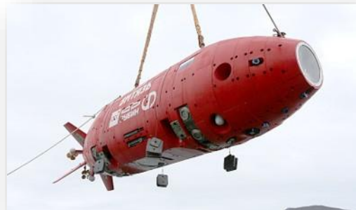
Демонстратор автономного комплекса сверглубоководного погружения «Витязь-Д». Фото: Фонд перспективных исследований
