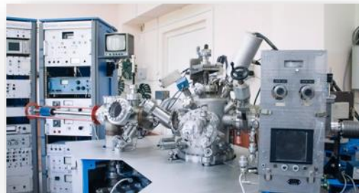
Аналитический комплекс для исследования химического состояния материалов методом рентгеновской фотоэлектронной спектроскопии. Фото: пресс-служба ОмГТУ
