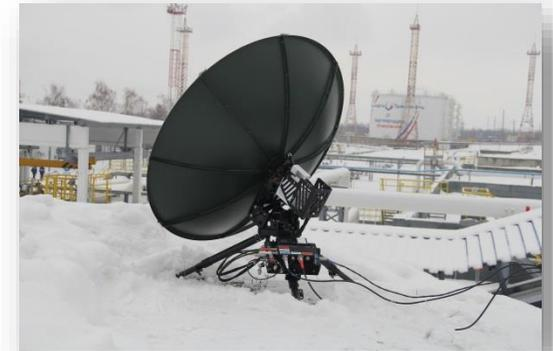
Мобильный комплекс спутникового видеонаблюдения (МКСВ). Фото: «Транснефть»
