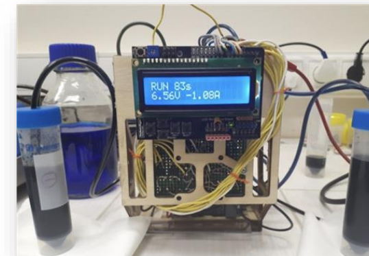
Лабораторный прототип поточного аккумулятора, созданный доцентом кафедры коллоидной химии МГУ Евгением Карпушкиным совместно с коллегами из Сколтеха. Фото: МГУ имени М.В. Ломоносова
