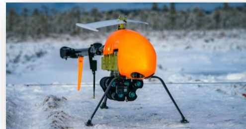
Беспилотник для доставки проб нефти. Фото: Газпром нефть
