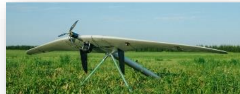
Беспилотный комплекс мониторинга уровня парниковых газов. Фото «Роснефть»
