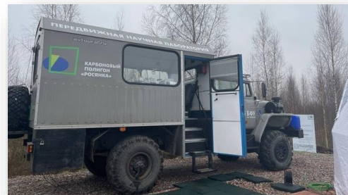
Мобильная лаборатория на солнечных батареях, для проведения экспресс-тестов проб торфа, воды и воздуха. Фото: government.ru
