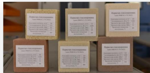
Образцы пористой стеклокерамики, разработанной в МГУ им. Н. П. Огарева. Фото: МГУ им. Н. П. Огарева
